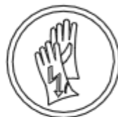
USO DE GUANTES DIELECTRICOS
